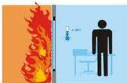
Las carpinterías para este tipo de vidrio están fabricados en acero galvanizado relleno de material ignifugo los acabados pueden ser de acero galvanizado , inox o de acero para pintar en cualquier color Ral.
